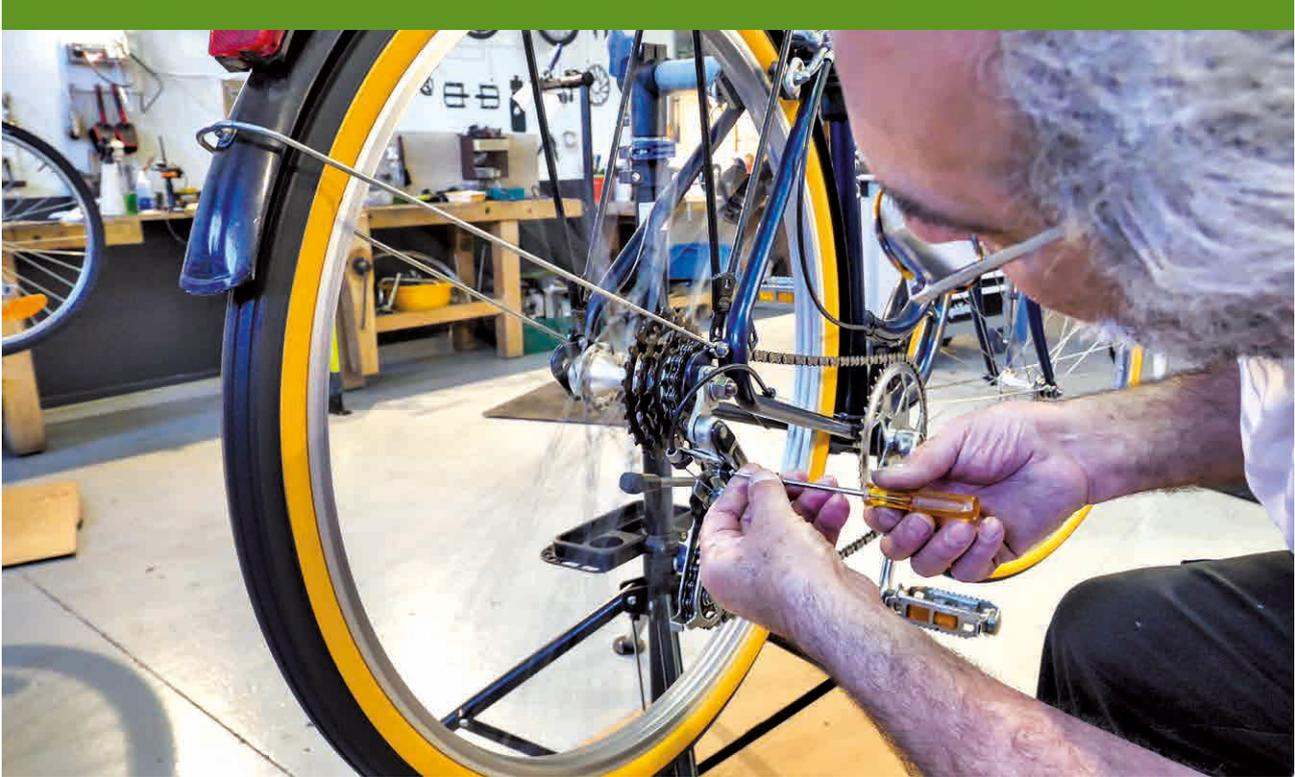
Avec les anciens cadres de vélo d'une part, et le stock de pièces récupérées d'autre part, les salariés effectuent le montage d'un vélo « reconditionné ». Ils assemblent le vélo en prenant soin de remplacer chaque élément trop usé et en installant les éléments neufs : poignées, câblages, tampons de frein, selle, etc. Si besoin, ils ont la capacité de repeindre et de relooker les cadres grâce aux cabines de peinture et de sablage disponibles dans l'atelier. Selon Poghos,
